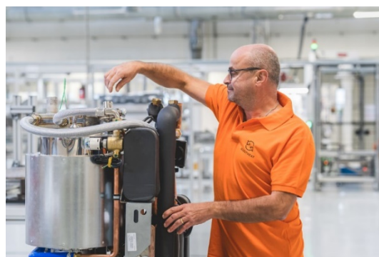
Assemblage du chariot thermodynamique de la BOOSTHEAT.20
